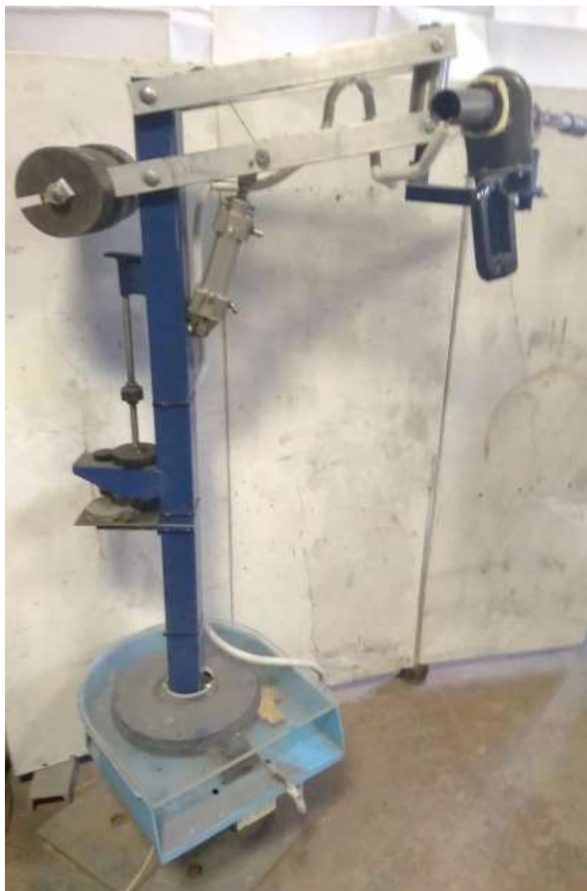
Рисунок 2.15 – Лабораторный образец усовершенствованного манипулятора для обслуживания кассетных ковшовых затворов
