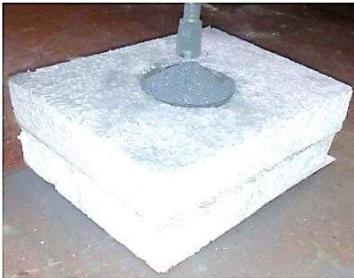
Рисунок 3.19 – Гнездовой блок выпускного канала модели сталеразливочного ковша заполненный смесью
