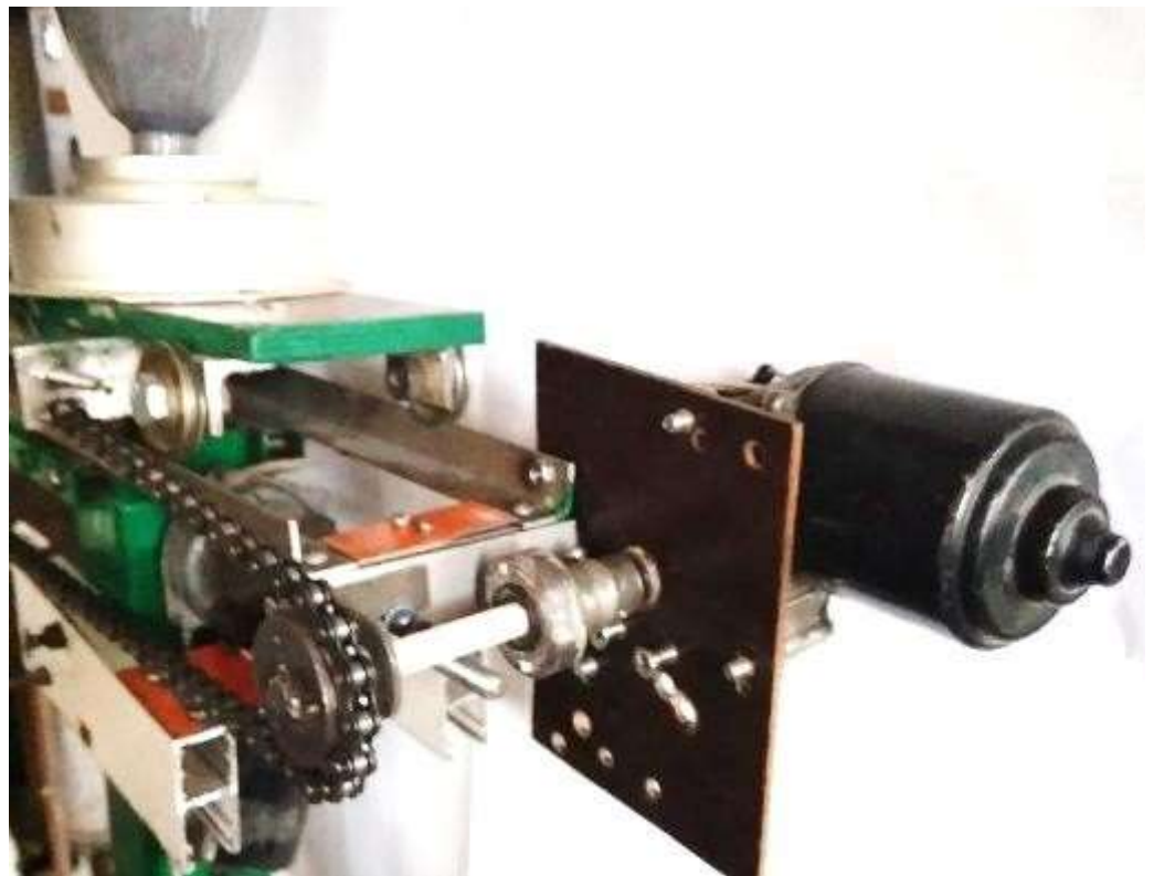
Рисунок 3.22 – Натурное исполнение механизма перемещения платформы относительно удлиненной верхней консоли
