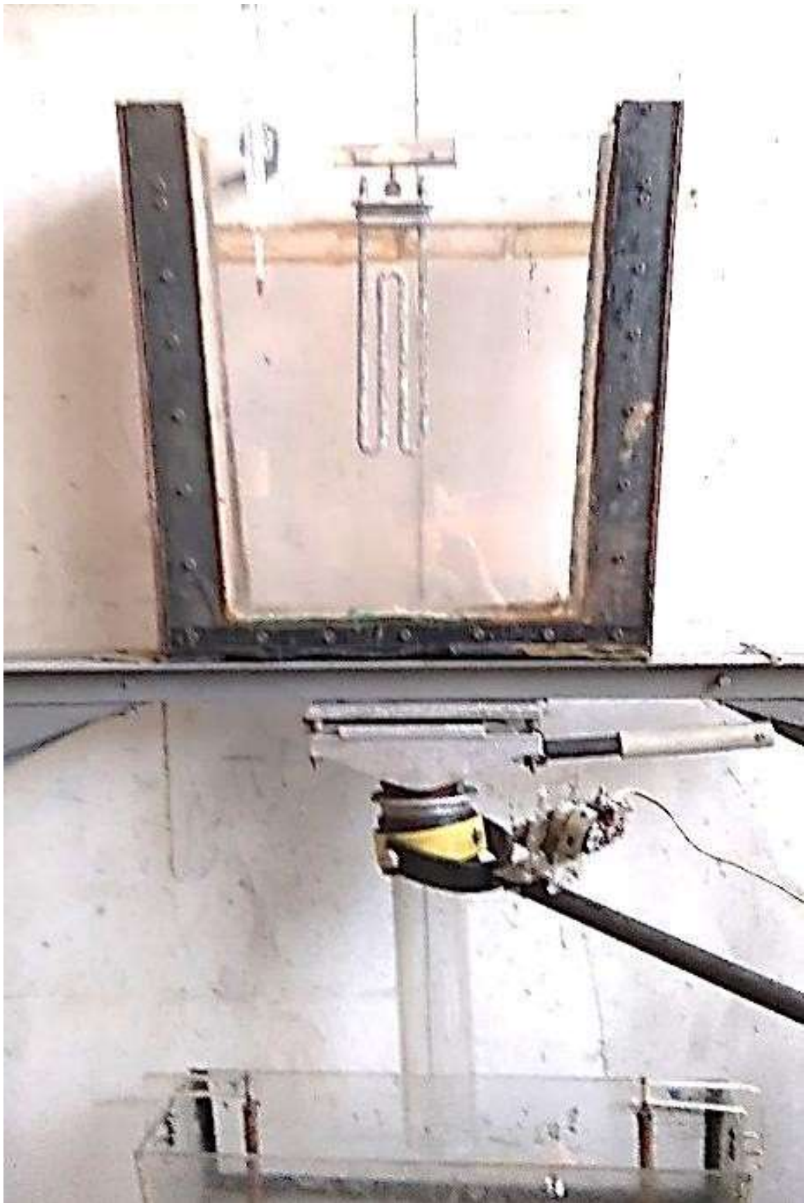
Рисунок 4.2 – Фотография экспериментальной установки для моделирования процесса зарастания канала защитной огнеупорной трубы
