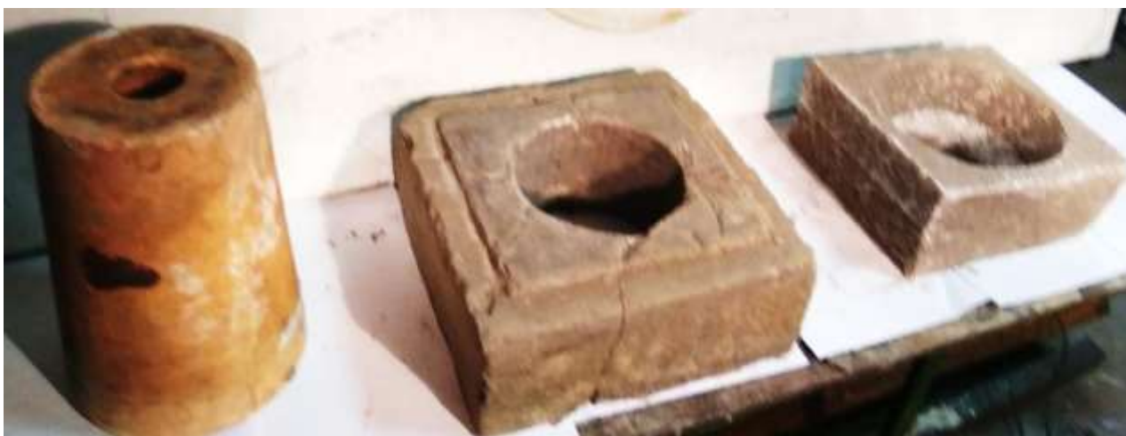
Рисунок 2.7 – Подготовленный к эксперименту комплект огнеупорных изделий гнездового блока 150-тонного разливочного ковша
