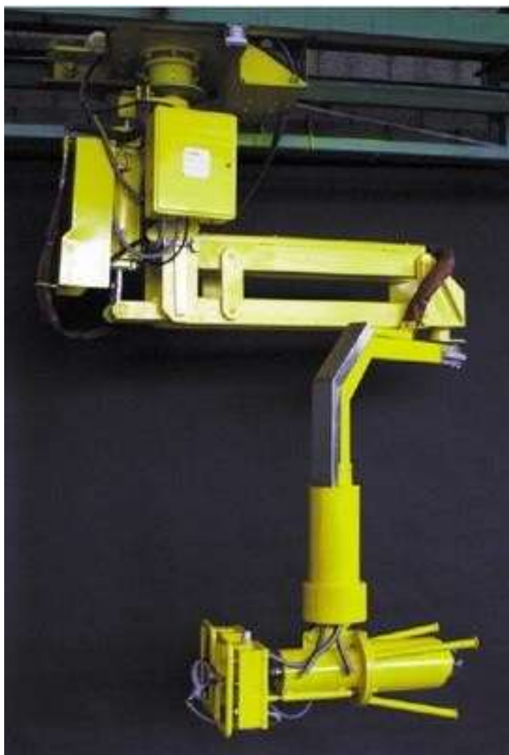
Рисунок 1.3 – Гидравлический манипулятор фирмы «RHI AG» для обслуживания кассетных ковшовых затворов
