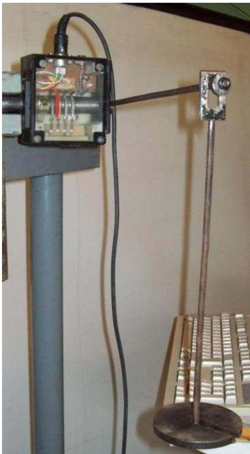
Рисунок 3.13 – Схема тарировки тензорезисторного преобразователя
