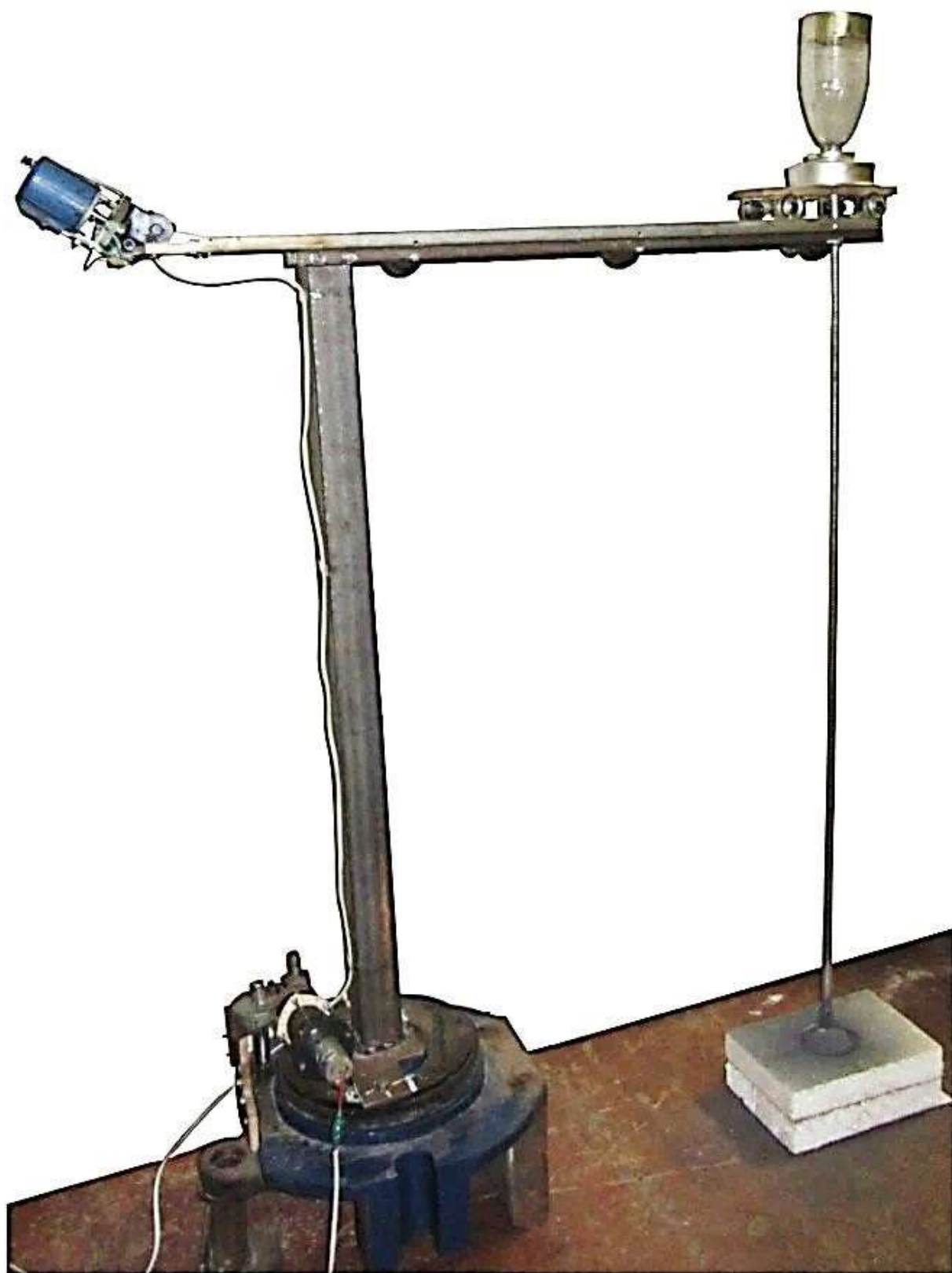
Рисунок 3.6 – Действующий натуральный образец манипулятора для механизированной подачи стартовой смеси в канал разливного стакана ковша
