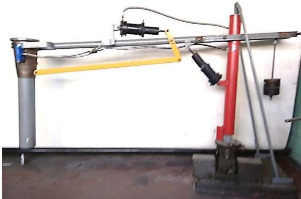
Рисунок 4.9 – Опытный образец модернизированного манипулятора для смены и удержания защитных огнеупорных труб при непрерывной разливке стали
