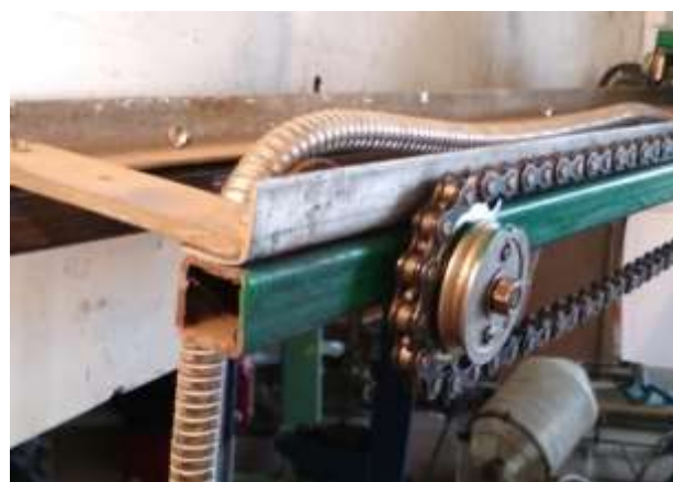
Рисунок 3.8 – Цепная передача механизма перемещения тележки, несущей расходный бункер со стартовой смесью
