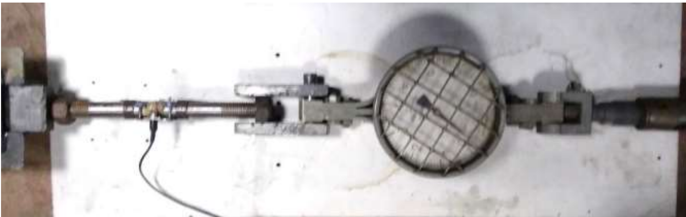
Рисунок 2.10 – Схема тарировки тензорезисторного преобразователя стержня
