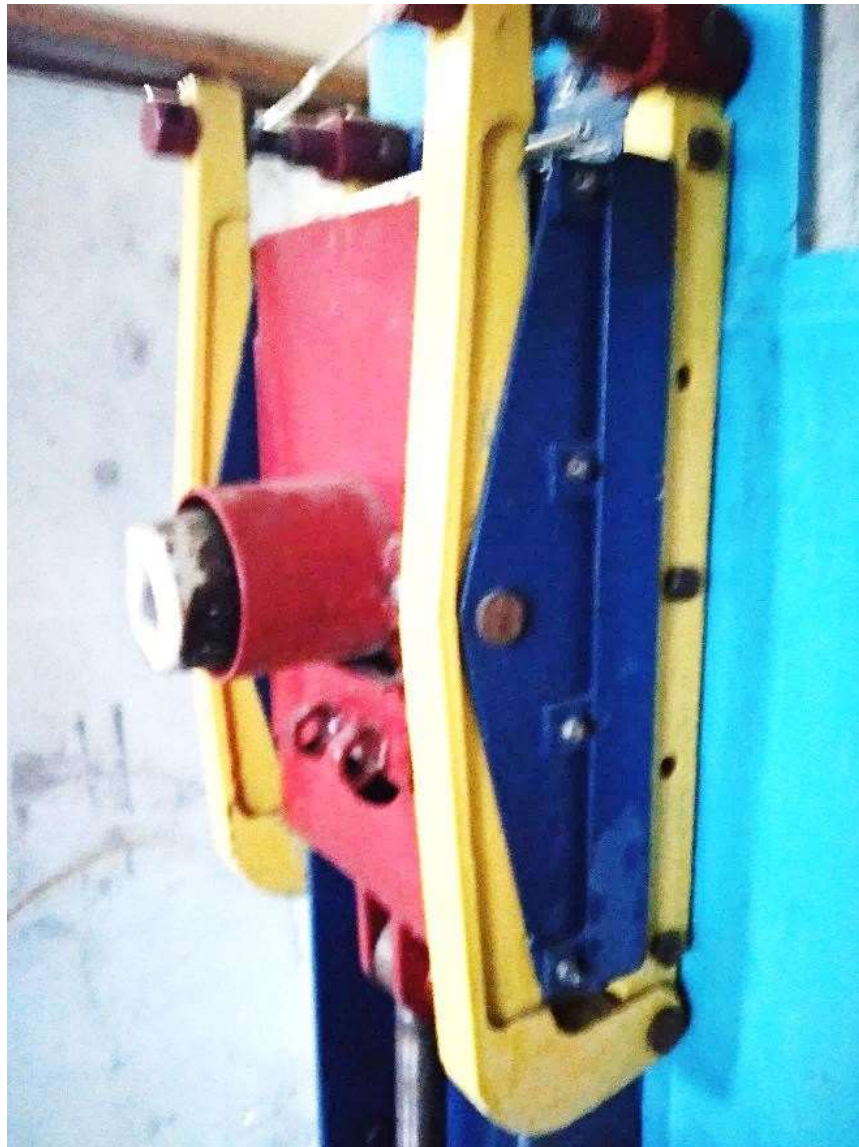
Рисунок 2.16 – Промышленный образец кассетного ковшового затвора, размещенный на испытательном стенде
