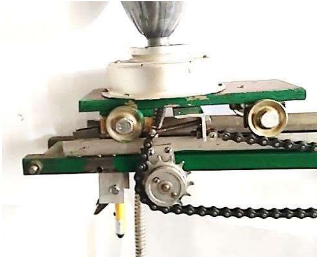
Рисунок 3.25 – Натурное положению элементов системы в момент срабатывания концевого выключателя
