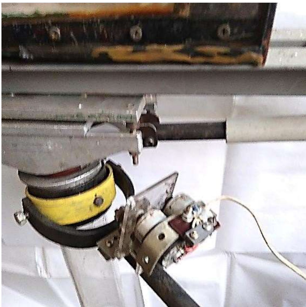
Рисунок 4.5 – Место размещения электромеханического вибратора направленного действия при моделировании разливки с использованием вибрационного воздействия на защитную трубу
