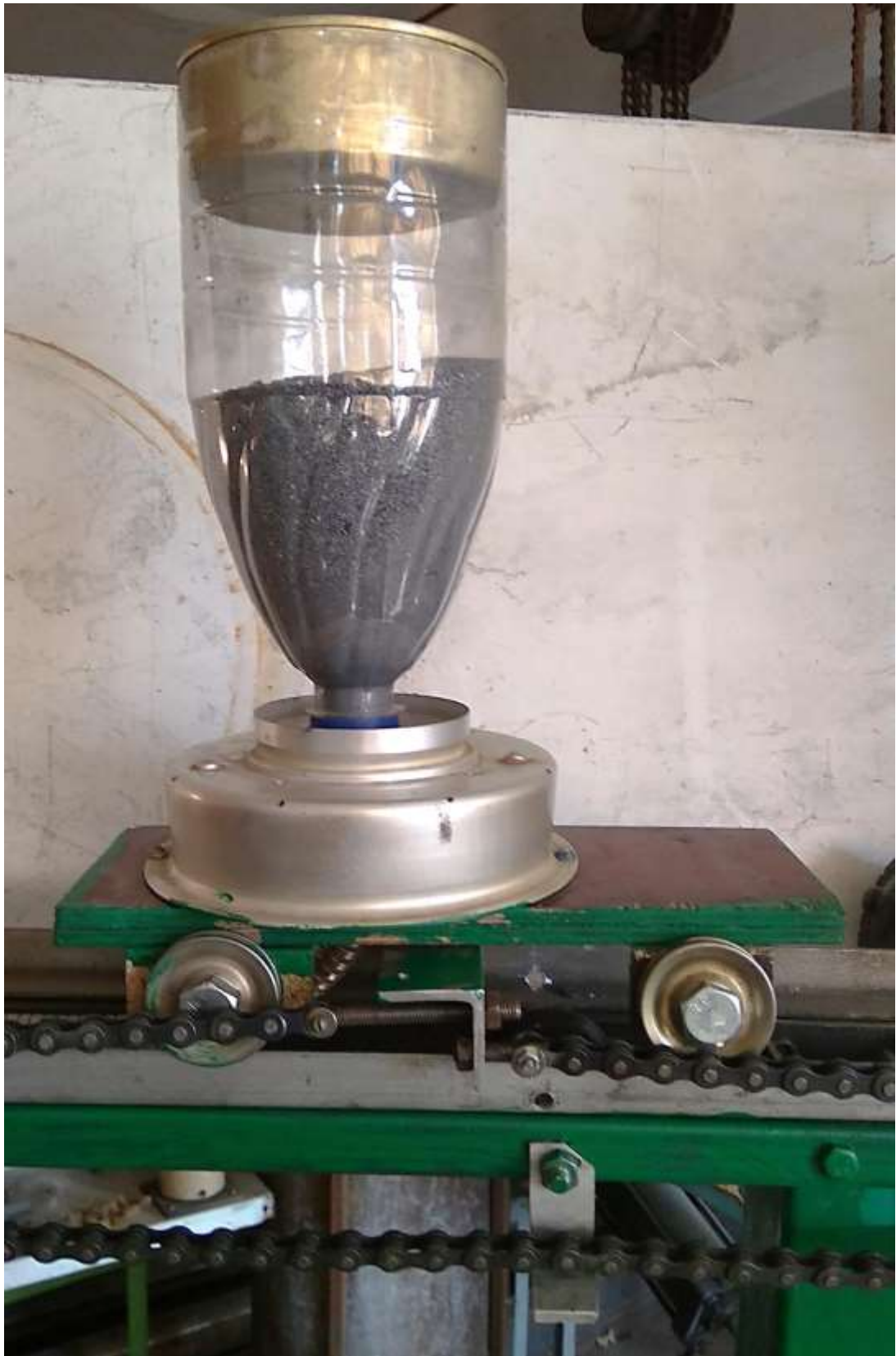
Рисунок 3.7 – Общий вид тележки с размещенным на ней бункером
