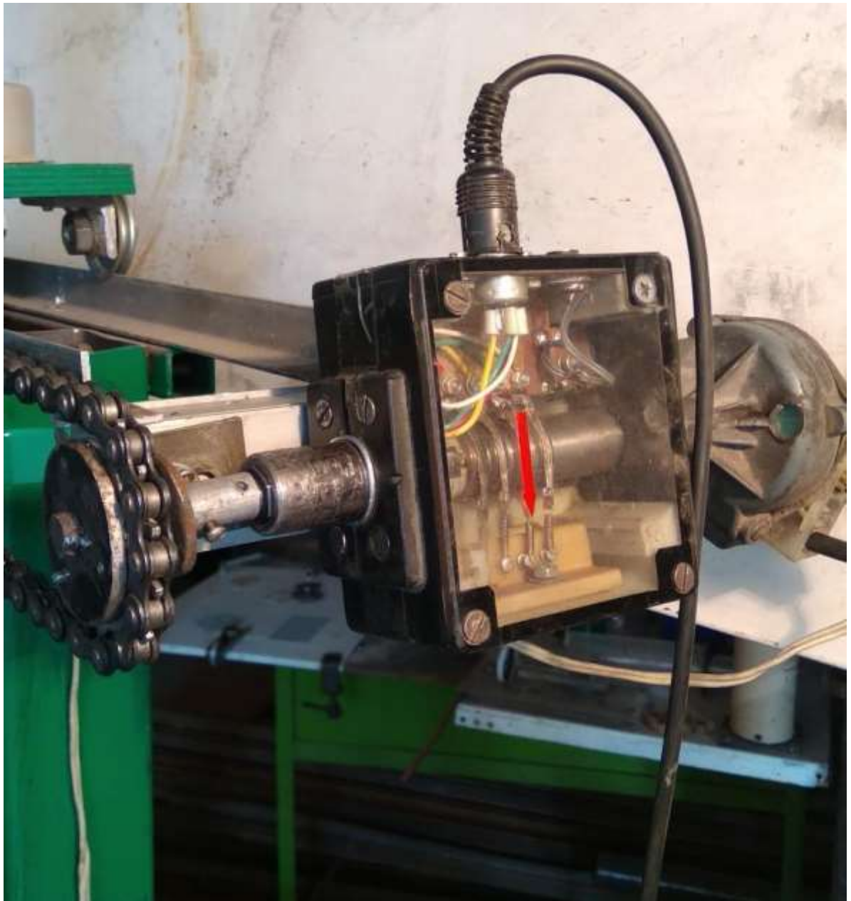
Рисунок 3.16 – Место установки тензорезисторного преобразователя при тестировании работы механизма перемещения тележки системы подачи стартовой смеси
