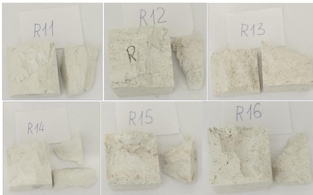
Рисунок 3.1– Фото образцов известняка R01...R06 после испытаний на предел прочности при сжатии
