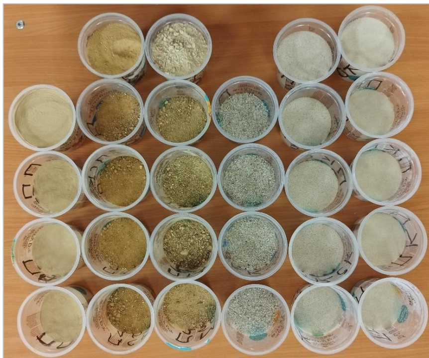
Рисунок 2.10 – Пробы дисперсных грунтов (песка) для испытаний на абразивность в зависимости от относительного содержания зерен кварца и их крупности, разделенные по фракциям
