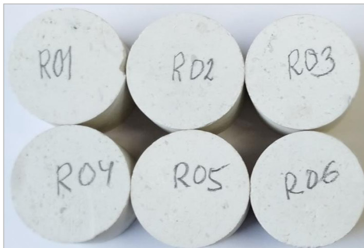
Рисунок 2.4 – Фото образцов известняка со станции Рижская БКЛ до испытаний на предел прочности при растяжении
