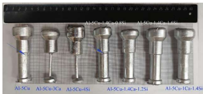
Рис.6.34. Внешний вид полученных отливок экспериментальных сплавов по карандашной пробе. Синие стрелки указывают на типично наблюдаемые горячие трещины [406].
