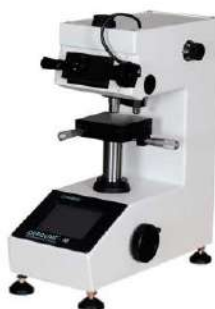
Рис. 2.5. Прибор для измерения твердости сплавов METKON DUROLINE MH-6.
