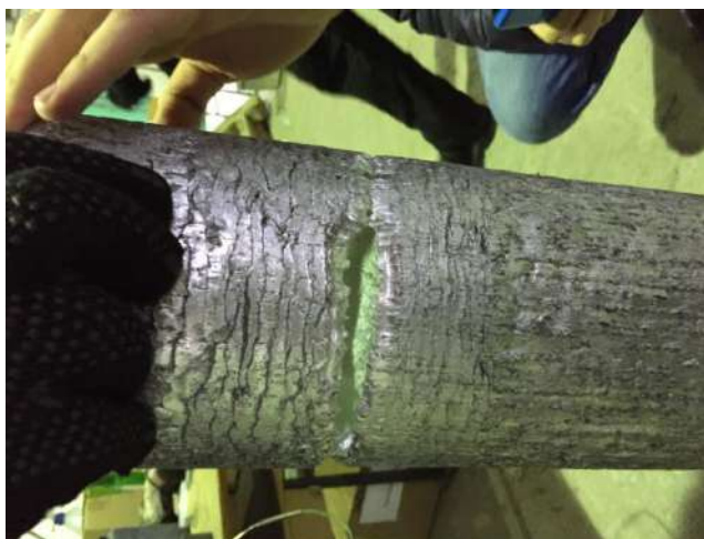
Рис.2.2. Внешний вид бракованных слитков, полученных при первых (пробных) заливках.
