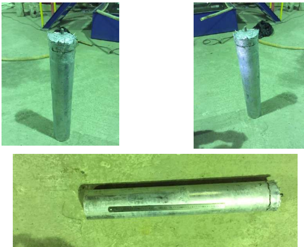
Рис.2.3. Внешний вид качественного слитка, полученного при оптимальном режиме плавки и литья.
