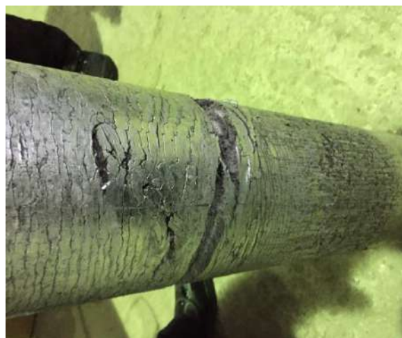
Рис.2.2. Внешний вид бракованных слитков, полученных при первых (пробных) заливках.
