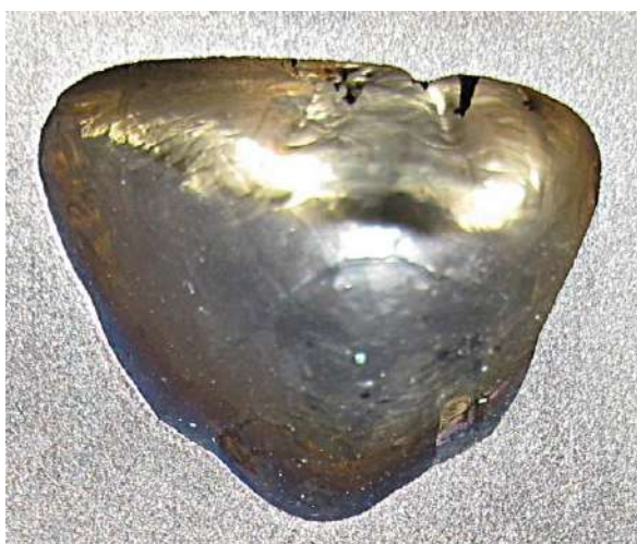
Рис.7.2.1 - 9. Крупная водородная раковина в литейной прибыли патрубка №1. \times 3 .
