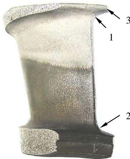
Рис. 3.4.1 – 1 Макроизображение лопатки РКТ двигателя РД 180. Стрелками отмечены местоположения очагов зарождения трещин: 1 – тип 1, 2 – тип 2, 3 – тип 3
