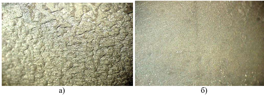
Рис. 3.4.3 – 5 Поверхность лопатки №15 СА двигателя РД 180; а – область эрозии, б – область равномерного окисления. Увеличено.
