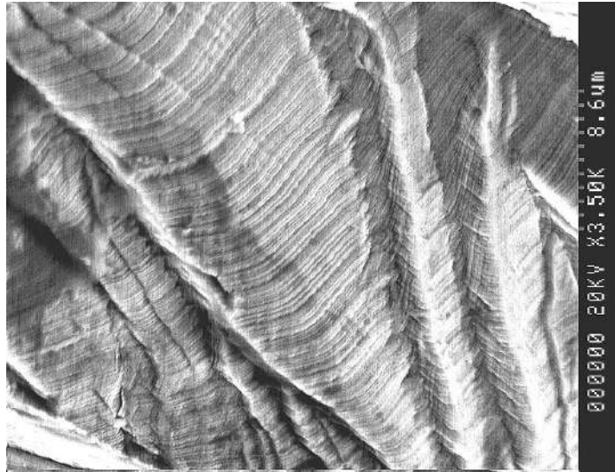
Рис. 2.7.1–4 Электронная фрактограммы поверхности трещины, образовавшейся на 9 – м ОИ.
