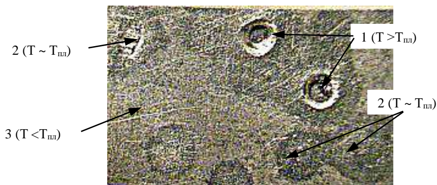
Рис.4.2.2.2 – 5 Макроизображение поверхности никелевого покрытия в области критического сечения КС с дефектами в виде проплавов и вспучиваний. Стрелками показаны: 1 – сквозные проплавы, 2 – области оплавления, 3 - не оплавленная поверхность. X 7
