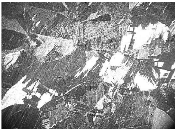
Рис.7.2.1 - 8. Макроструктура материала патрубка, средний размер зерна \sim 1.4 мм.
