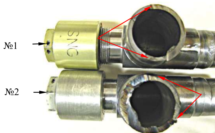
Рис.5.1 – 4 Макроизображение изломов на тройниках трубопроводов № 1 и №2. Двойными стрелками отмечено местоположение усталостных трещин, стрелками отмечены заглушки.
