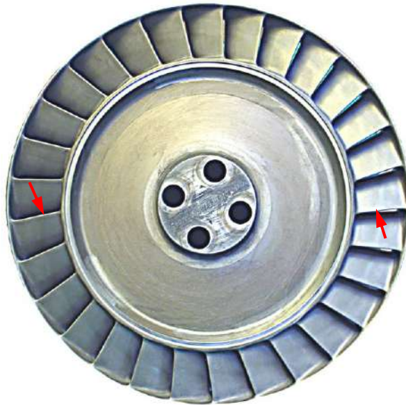
Рис.3 – 1 Внешний вид рабочего колеса турбины двигателя РД 180 со стороны выходных кромок лопаток (показаны стрелками).
