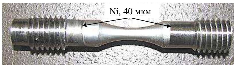
Рис. 2.5 - 1 Корсетный образец с никелевым покрытием на рабочей части. Увеличено.
