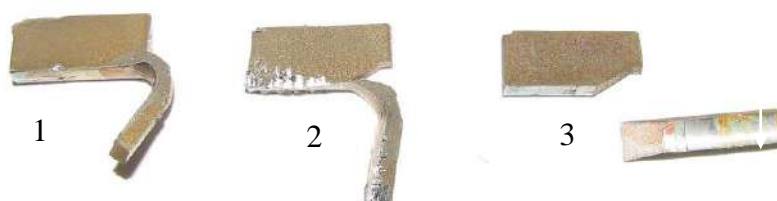
Рис. 1.2.2 – 6 Внешний вид плоских образцов после принудительного разрушения паяного шва. Цифрами показаны: 1 – не разрушенный шов, 2 – разрушение по материалу шва, 3 – разрушение по границе паяный шов – поверхность проставки.
