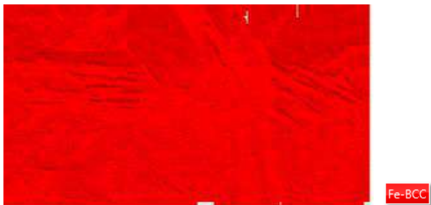
Рис. 8.2 – 5 Карта фазового состава образца ЖТ-16, 100% \alpha – фазы.
