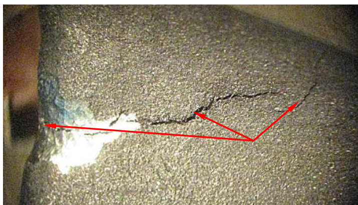
Рис. 7.2.1-2 Макрофотография сквозной трещины в ребре жесткости (отмечена стрелками, светлая область на кромке ребра – результат механической зачистки). Увеличено.
