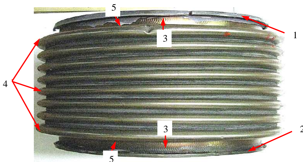
Рис. 7.2.3 - 1 Внешний вид компенсатора. Стрелками показаны: 1, 2 – кольца фланцев, 3 – сварные швы, 4 – гофры сильфона, 5 – изгибы гофра. Уменьшено.
