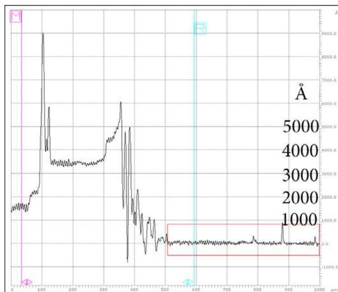
Рисунок 6.23 – Профиль облученной YAG/Nd 3+ -лазером поверхности ГЭС КРТ МЛЭ № 040107, измеренный на профилометре “Dektak-8”. Плотность мощности 5,6 МВт/см 2 , \tau_{\text{и}} = 25 нс. Видно, что из облученной части (выделенная область) произошло испарение материала на глубину около 0,1 мкм.
