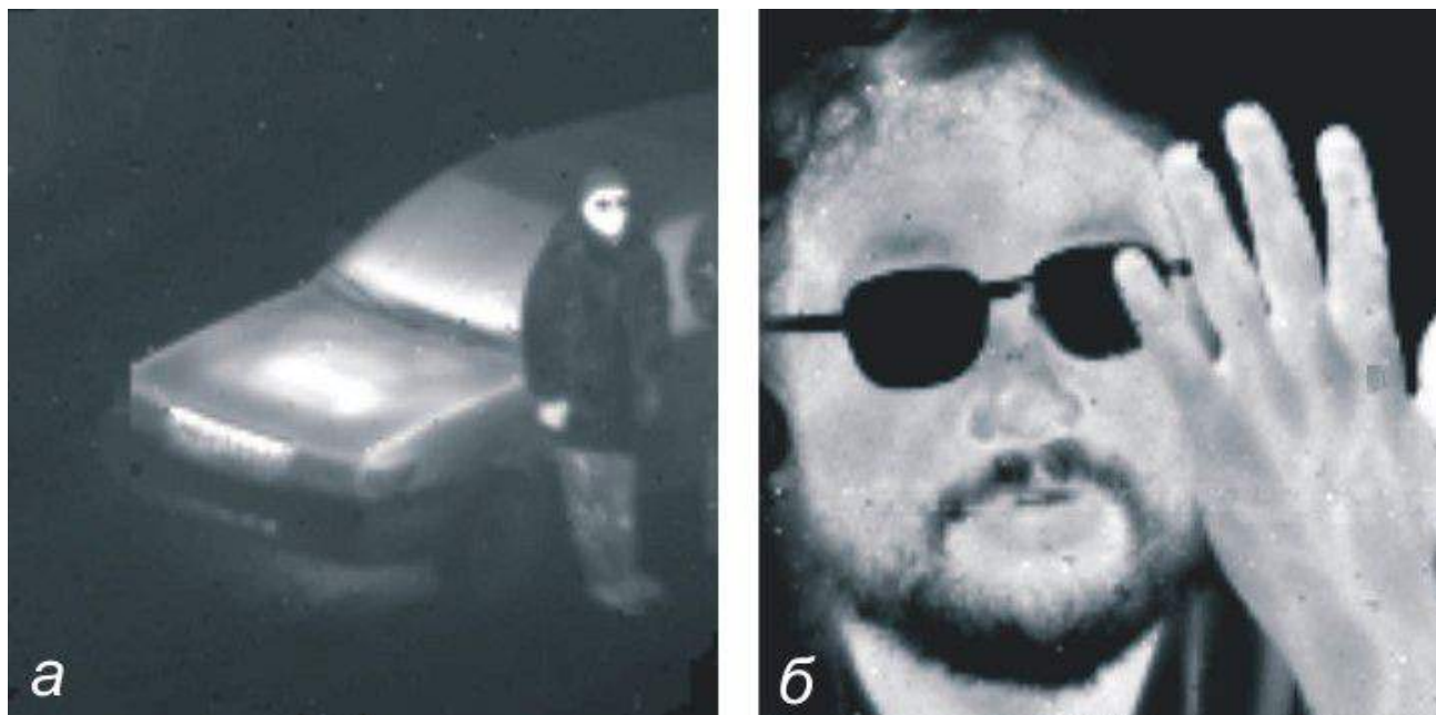
Рисунок 7.23 – Примеры тепловых изображений, полученных с помощью матричных фотоприемных модулей размерностью 128 \times 128 элементов. \lambda_c : а – 6,0; б – 8,7 мкм.
